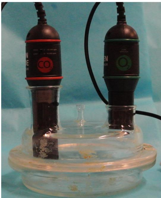
Fig. 1. La caja Petri modificada que permite la medición en línea del oxígeno consumido y el dióxido de carbono producido durante el crecimiento de *Aspergillus niger* A10.
